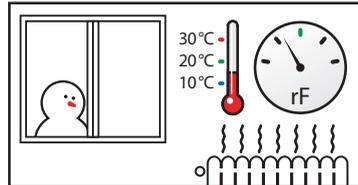
**Winter:** Heizt man nach dem Fensterschließen nun den Raum wieder auf, dann sinkt automatisch die **relative Luftfeuchtigkeit**, denn die kalte Luft kann durch das Erwärmen mehr Wasserdampf aufnehmen.
