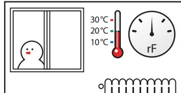
**Ausgangssituation Winter:** Außentemperatur liegt bei 3 °C, innen ist es 21 °C und die **relative Luftfeuchtigkeit** liegt innen und außen bei 50 %. Da die Luft außen sehr kalt ist, kann sie wenig Wasserdampf aufnehmen. Die **absolute Feuchte** ist demzufolge niedrig.
